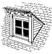
lucarne retroussée , ou à demoiselle ; c'est aussi le vrai chien assis
